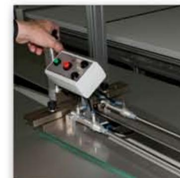
Images en haut : les guides sont rapidement interchangeables. A la demande, des guides spécifiques, tel que pour un ruban à boucles, peuvent être fournis.
