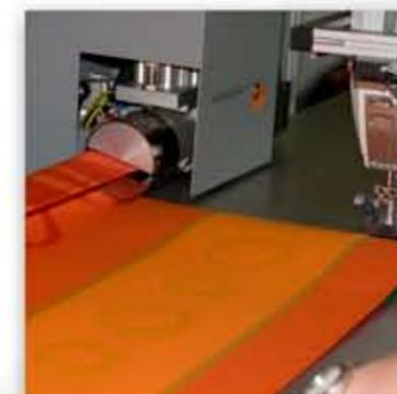
Un enrouleur, en option, garantit un enroulement successif, rapide et sans froissement des lés cousus. Les contrôles de l'enrouleur reconnaissent la position du lé et arrêtent automatiquement l'enroulement là où le lé suivant doit être cousu.
